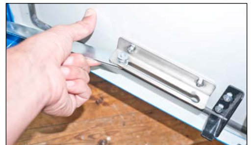
Abb. 16: Entriegeln der Türarretierung
