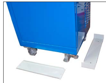
Abb. 37: Sockel-Blenden ECC 320 demontiert
